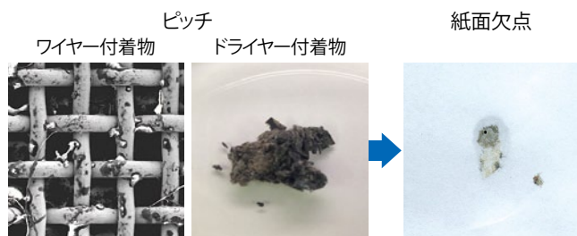
図1 堆積・付着したピッチと紙面欠点
