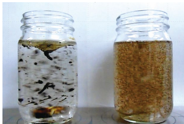
水道水 AS 水溶液 図3 水中におけるピッチの分散性
