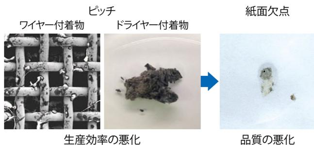
図1 堆積・付着したピッチと紙面欠点
