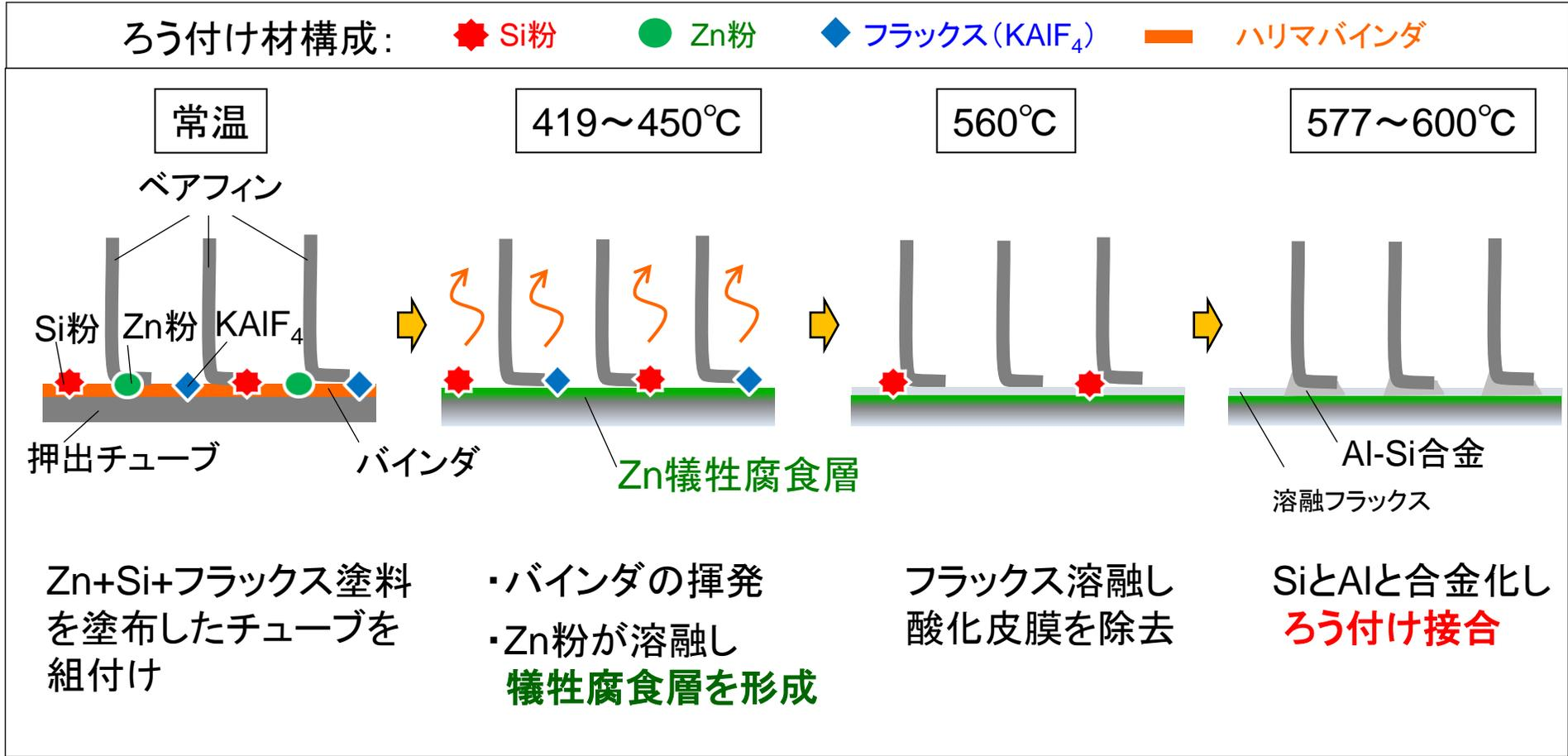
接合だけでなく耐食性も向上させて、安価なクラッドレスフィンが適用可能
