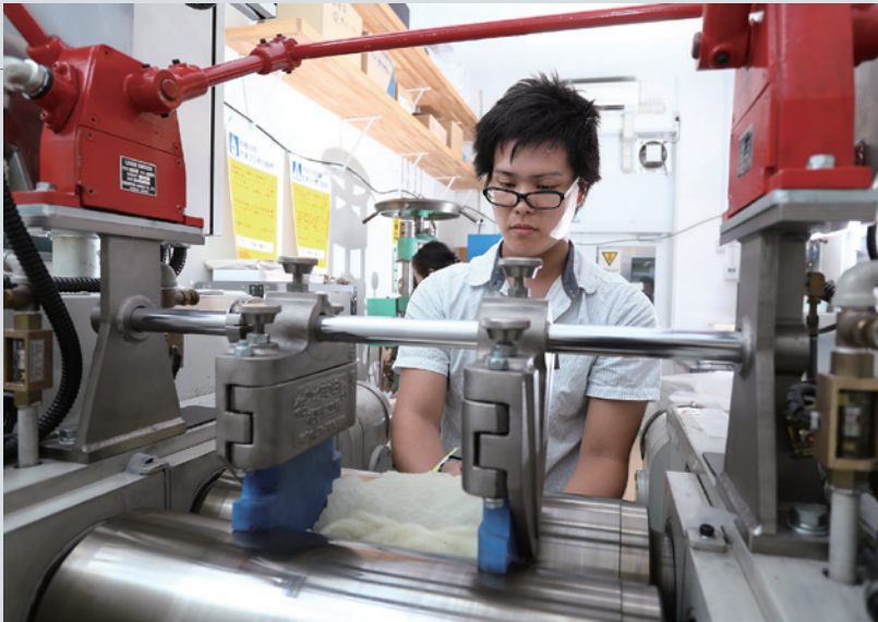
ゴム練り機。ゴムを練っているときにカーボンブラックを混ぜる。
