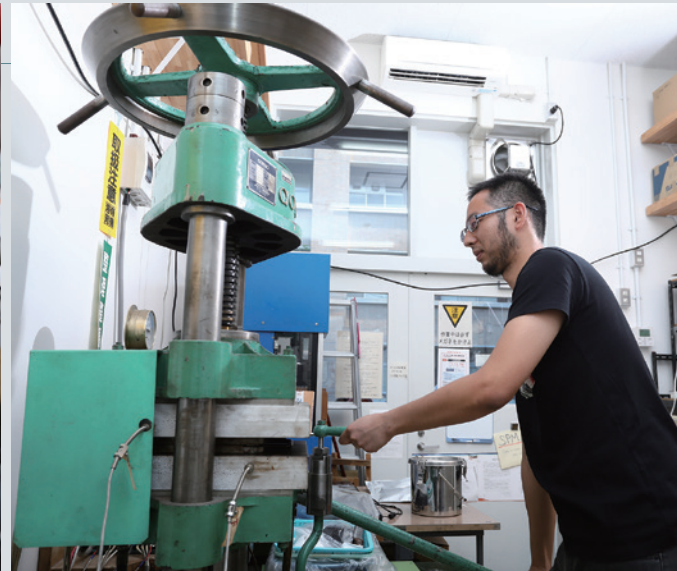
熱プレス機。練ったゴムを金型に入れ、プレス機で圧力かける。
