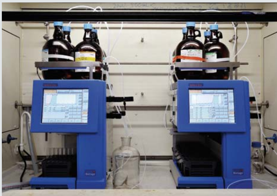
反応合成物の単離精製には、フラッシュ自動精製システムを活用して実験の効率化を向上させる
