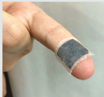
人差し指の上に乗せた紙の蓄電デバイス（蓄電紙）試作品第1号。
