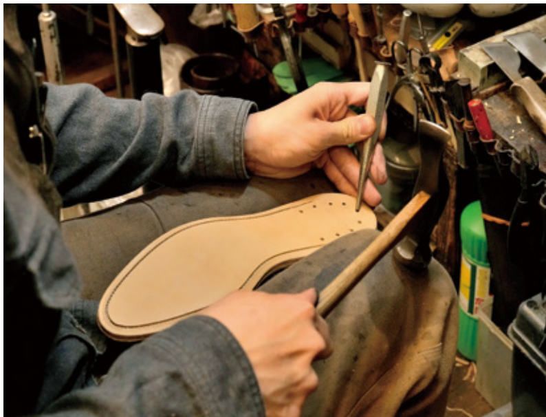
靴底を固定させる釘を打つ回数は多くて3回。打つ回数が少なければ少ないほどよい。戸棚にはいい具合に錆びた釘が出番を待っている
