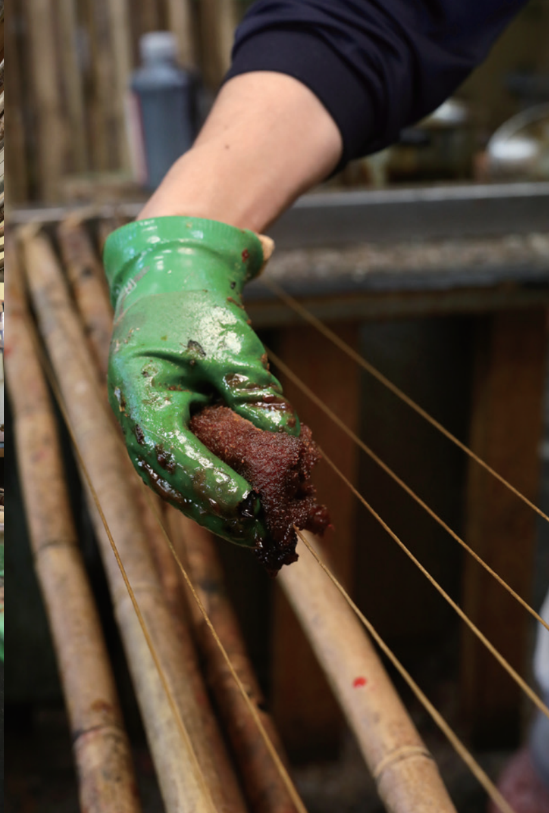
仕上げに松やにをひまし油で煮て練り合わせた薬練を塗る。
