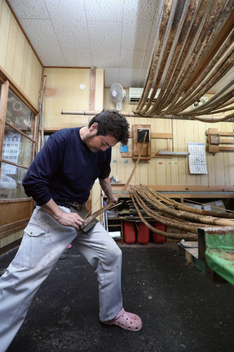
弦を竹に張り、水で濡らしたスポンジで何度も上下にこき下ろす。
