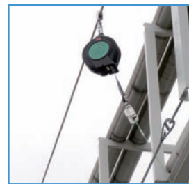
▲ローリー荷下り場の安全帯と煎り付けケーブルおよび安全ブロッコ設置
