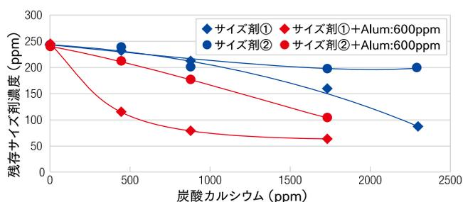
図8 エマルジョンサイズ剤の炭カルへの吸着性抑制
